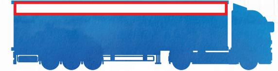
Durch erhöhte Geschwindigkeiten im Bahntransport sowie die auf die Plane einwirkenden Kräften kann es zum Lösen des Planenverdecks kommen. Dies führt zum sogenannten Planenflattern.
