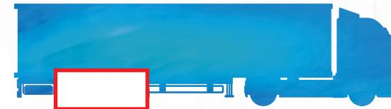
Die Anti-Spray-Schutz-Vorrichtung, der sogenannte Schmutzfänger, hat die Aufgabe, Sprühnebel durch aufwirbelndes Spritzwasser bei nasser Straße zu verhindern.
